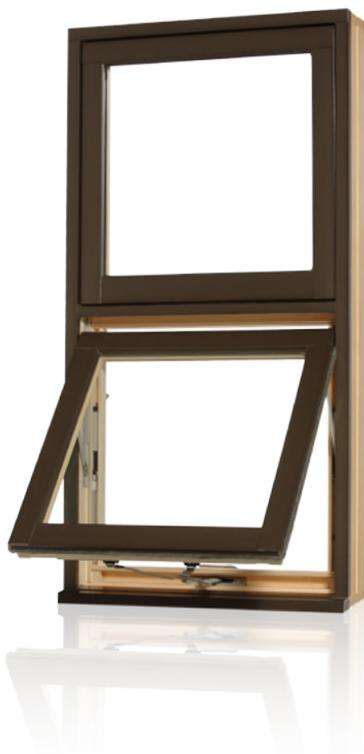
Ces fenêtres comptent sur une construction structurale, un seuil monopièce incliné, l'utilisation de coupe-froid et de verre scellé pour garantir leur solidité exceptionnelle, leur résistance aux infiltrations d'air et d'eau et leur rendement énergétique supérieur. Les fenêtres à auvents s'ouvrent du bas vers l'extérieur, grâce à un système de levier réglable. Ce mode d'ouverture permet une très bonne ventilation dans toute la maison, même les jours de pluie.
